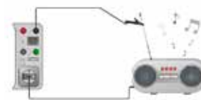
Prueba de corriente de fuga de contacto para dispositivos de Clase II
