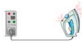
Prueba de corriente de fuga del conductor PE para equipos de Clase I
