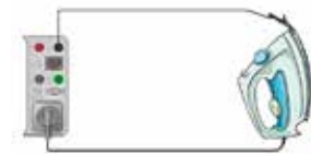
Prueba de resistencia de tierra
