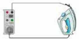
Prueba de corriente de fuga alternativa para un equipo Clase I
