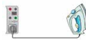
Prueba de resistencia de aislamiento para dispositivos de Clase I
