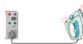
Prueba de corriente de fuga de diferencial para dispositivos de Clase I
