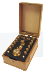
Este potenciómetro de calibración de 1900 se utilizaba con una celda de Weston y un galvanómetro como el que se muestra arriba. Su precio: ¡195 francos!
